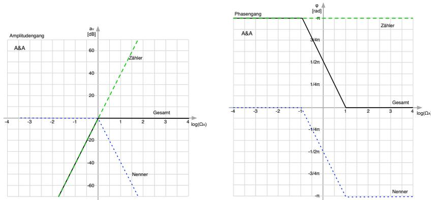
(h) Die Diagramme der Schaltung B mit der Verstärkung 20 dB:
