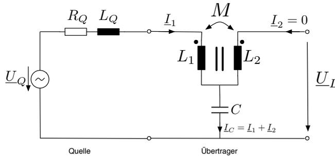
Zwei Maschengleichungen können aufgestellt werden. Es darf nicht vergessen werden, dass in diesem Fall der Strom der Sekundärseite  $\underline{I}_2 = 0$  ist.
