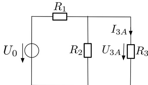
Die Spannung  $U_{3A}$  kann über einen Spannungsteiler berechnet werden:
