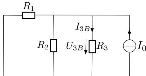
Der Strom  $I_{3B}$  kann über einen Stromteiler berechnet werden:
