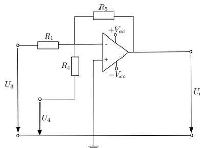
$$\frac{-U_0}{R_5} = \left( \frac{U_3}{R_1} + \frac{U_4}{R_4} \right)$$
