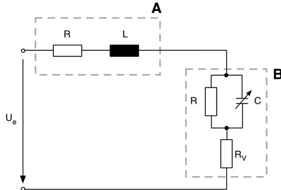
Ein Verbraucher (Schaltungsteil B) ist über eine lange reale, verlustbehaftete Leitung (Schaltungsteil A) an eine Spannungsquelle  $U_e$  angeschlossen. Der Verbraucher besteht aus dem eigentlichen rein reellen Verbraucher  $R_V$  und einer vorgeschalteten Kapazität C. Dieser Kondensator C hat die Funktion die Blindleistung, die durch die induktive lange Leitung hervorgerufen wird, zu kompensieren.
