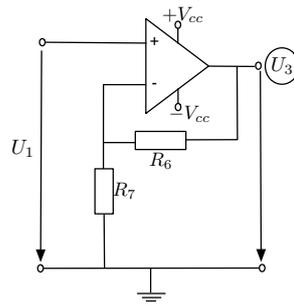
$$\frac{U_1}{R_7} = \frac{U_3}{R_6 + R_7}$$
