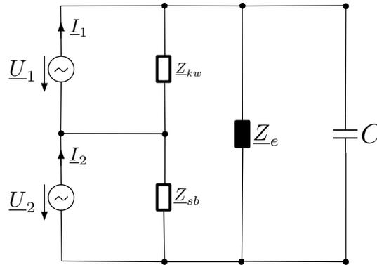
Wie groß muss der Blindleitwert  $\omega C$  des Kondensators sein, wenn die gesamte Blindleistung in der Hütte kompensiert werden muss?
