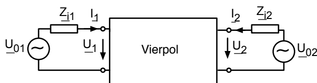
Abb. 11.5: Beschaltung des Vierpols durch Thevenin-Ersatzschaltungen
