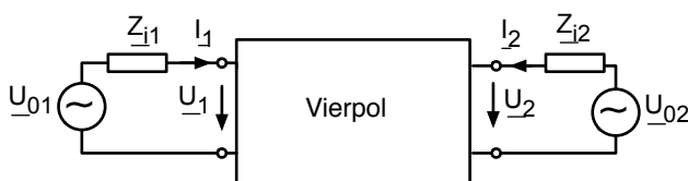
Abb. 11.5: Beschaltung des Vierpols durch Thevenin-Ersatzsschaltungen
