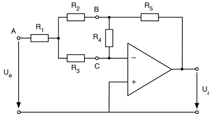
Zunächst wird das Netzwerk A,B,C in eine Dreieckschaltung umgewandelt. Aufgrund der Symmetrie ( $R_1 = R_2 = R_3$ ) sind die Zweigwiderstände auch gleich groß ( $R_{AB} = R_{AC} = R_{BC}$ ).
