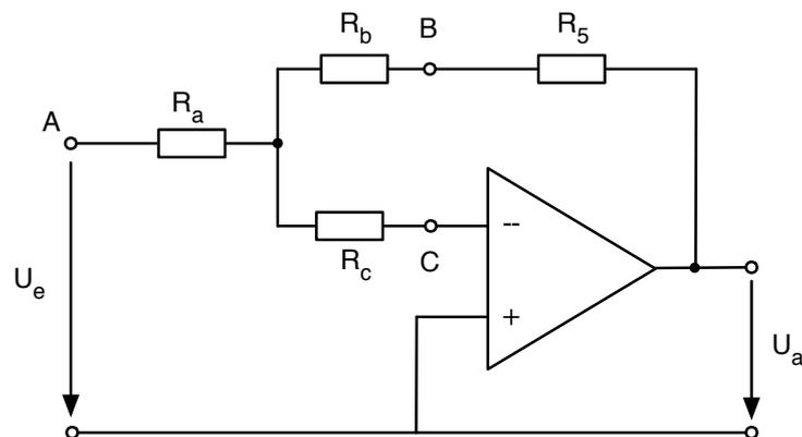
Die beiden Widerstände  $R_b$  und  $R_5$  im Rückkopplungszweig liegen in Serie und können leicht zusammengefasst werden.
