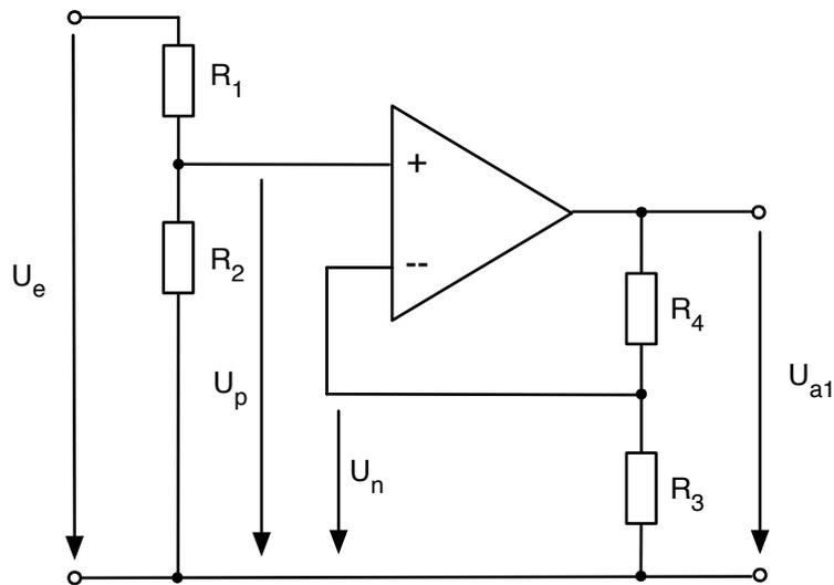
Hier können zwei Spannungsteiler verwendet werden.
