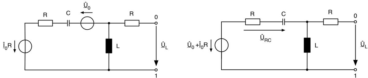
Im Leerlauf fließt durch den rechten Widerstand  $R$  kein Strom, d.h. es fällt auch keine Spannung ab. Die Leerlaufspannung liegt somit an der Spule an.
