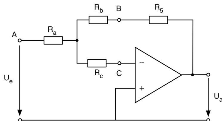
Die beiden Widerstände  $R_b$  und  $R_5$  im Rückkopplungsweig liegen in Serie und können leicht zusammengefasst werden.
