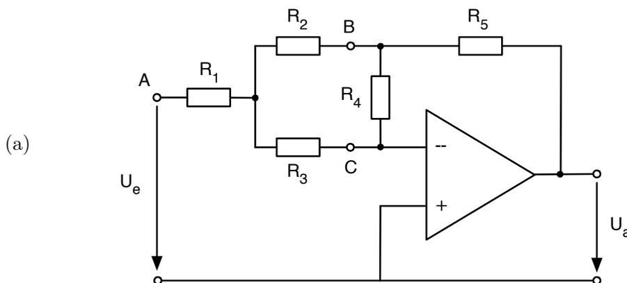
Zunächst wird das Netzwerk A,B,C in eine Dreieckschaltung umgewandelt. Aufgrund der Symmetrie ( $R_1 = R_2 = R_3$ ) sind die Zweigwiderstände auch gleich groß ( $R_{AB} = R_{AC} = R_{BC}$ ).
