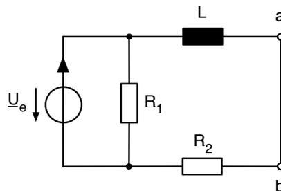
Die Blindleistung  $Q$  und die Wirkleistung  $P$  erhalten wir als Imaginär- bzw. Realteil der Scheinleistung  $\underline{S}$ .  $\underline{S}$  wiederum lässt sich über den Zusammenhang  $\underline{S} = \underline{U} \cdot \underline{I}^* = \underline{U} \underline{U}^* \underline{Y}^* = U^2 \underline{Y}^*$  berechnen.
