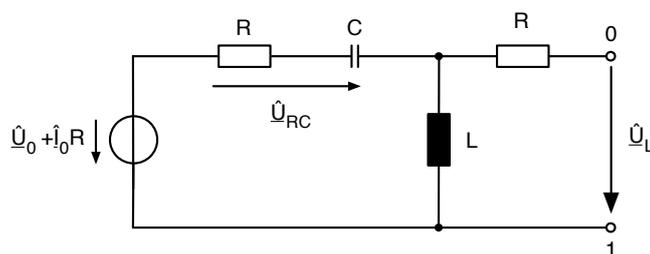
Im Leerlauf fließt durch den rechten Widerstand  $R$  kein Strom, d.h. es fällt auch keine Spannung ab. Die Leerlaufspannung liegt somit an der Spule an.
