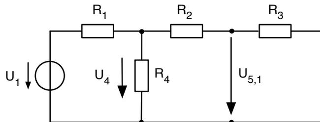
$U_{5,1}$  kann über die Spannungsteilerregel ermittelt werden.
