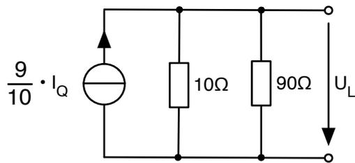
Nun noch die Parallelschaltung auflösen, wieder eine Spannungsquelle bilden und man erhält die gesuchte Anordnung
