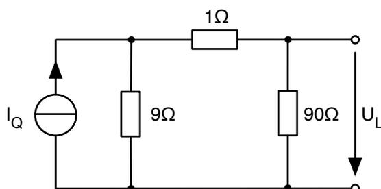
$$10\Omega \parallel 90\Omega = \frac{10\Omega \cdot 90\Omega}{10\Omega + 90\Omega} = 9\Omega$$
