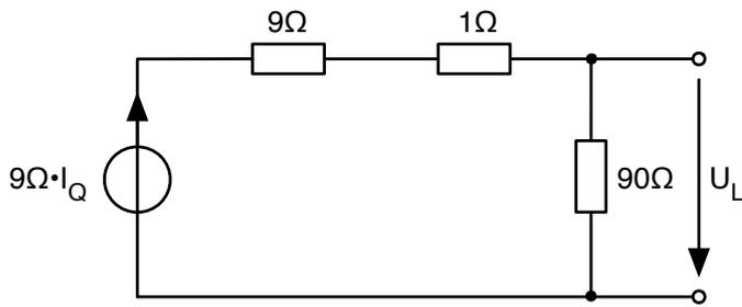
Die beiden Widerstände zusammenfassen und wieder in eine Stromquelle transformieren
