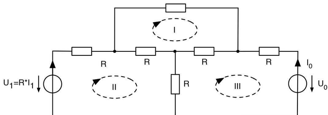
Aus diesem Schaltplan können die Werte für die Widerstandsmatrix und den Quellenspannungs-Vektor abgelesen werden.
