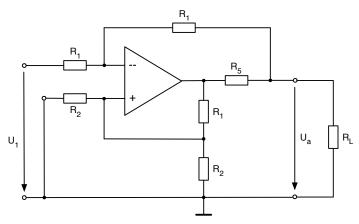
Die beiden parallelen  $R_2$  können zusammengefasst werden:  $R_2\|R_2=\frac{R_2R_2}{R_2+R_2}=\frac{1}{2}R_2$
