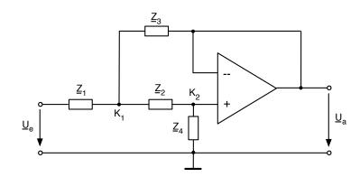
(a) Berechnen Sie das Spannungsverhältnis  $\frac{\underline{U}_a}{\underline{U}_e}$  in Abhängigkeit von  $\underline{Z}_1$ ,  $\underline{Z}_2$ ,  $\underline{Z}_3$  und  $\underline{Z}_4$ .
