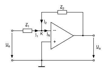
Wegen  $\underline{I}_N = 0$  (in einen idealen OP fliesst kein Strom) gilt  $\underline{I}_1 = -\underline{I}_2$ . Formuliert man diese Bedingung mit Spannungen und Widerständen:
