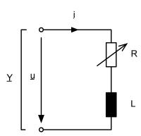
(a) Für  $R=0\Omega$  verbleibt nur noch die komplexe Impedanz  $\underline{Z}=j\omega L=j10\Omega$  im Stromkreis. Die komplexe Amplitude des Stroms  $\underline{i}$  berechnet sich über den Ohmschen Zusammenhang von Spannung und Impedanz:
