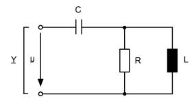
(a) Berechnen Sie die komplexe Impedanz  $\underline{Z}(j\omega)$ , d.h. die Schaltung von links gesehen, den Realteil  $Re\{\underline{Z}(j\omega)\}$  in allgemeiner Form, d.h. in Abhängigkeit von R, C, L und  $\omega$ .
