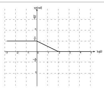
(c) Übertragungsfunktion der Schaltungen aus a) und b) zusammengefasst:  $\underline{G}_{res}(j\omega) = \underline{\frac{U_{a2}}{U_e}} = \underline{G}_1(j\omega) \cdot \underline{G}_2(j\omega) = -\frac{1+j\omega C_1 R}{j\omega C_1 R} \cdot \frac{j\omega C_2 R}{1+j\omega C_2 R}$  Die zeichnerische Kombination ergibt:
