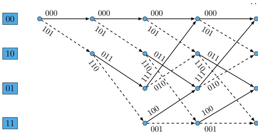
e) Da die Bits vor Übertragung über den AWGN Kanal BPSK moduliert werden und eine Soft-Decision genutzt werden soll, kann  $\sum_i (-1)^{x_i} \cdot r_i$  als Metrik genutzt werden, wobei  $r_i$  das  $i$ -te Empfangssymbol und  $x_i$  das  $i$ -te Bit des betrachteten Pfades darstellt. Nach dem zweiten Taktschritt ergibt sich:
