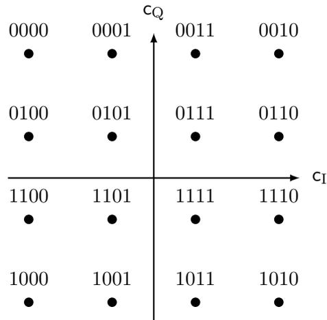
Damit die Zuordnung der Bitmuster zu den Symbolen einer Gray-Codierung folgt, müssen sich im Sinne des euklidischen Abstandes benachbarte Modulationssymbole um ein Bit unterscheiden. Bei einer 16-QAM kann die Gray-Codierung für 2 Bit für Inphase und 2 Bit für Quadratur unabhängig bestimmt werden und dann für die gesamte 16-QAM zusammengeführt werden.
