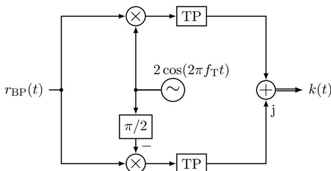
Das Empfangssignal wird aufgeteilt, wobei es einmal mit einer Cosinus-Schwingung und einmal mit einer Sinus-Schwingung gemischt wird. Beide kommen aus dem gleichen Oszillator mit einer Frequenz möglichst gleich der Trägerfrequenz, hier also  $f_T = 1$  kHz. Die Sinus-Schwingung wird durch eine  $\pi/2$ -Phasendrehung des Signals aus diesem Oszillator erzeugt.
