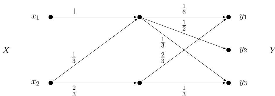
Gegeben ist obiges Modell eines diskreten, gedächtnislosen Kanals. Die Zufallsvariablen  $X$  und  $Y$  beschreiben das Sende- und Empfangssymbol, wobei  $\mathcal{X} = \{x_1, x_2\}$  die Menge der Sendesymbole und  $\mathcal{Y} = \{y_1, y_2, y_3\}$  die Menge der Empfangssymbole ist. An den Kanten sind die Übergangswahrscheinlichkeiten zwischen den verschiedenen Knoten notiert.
