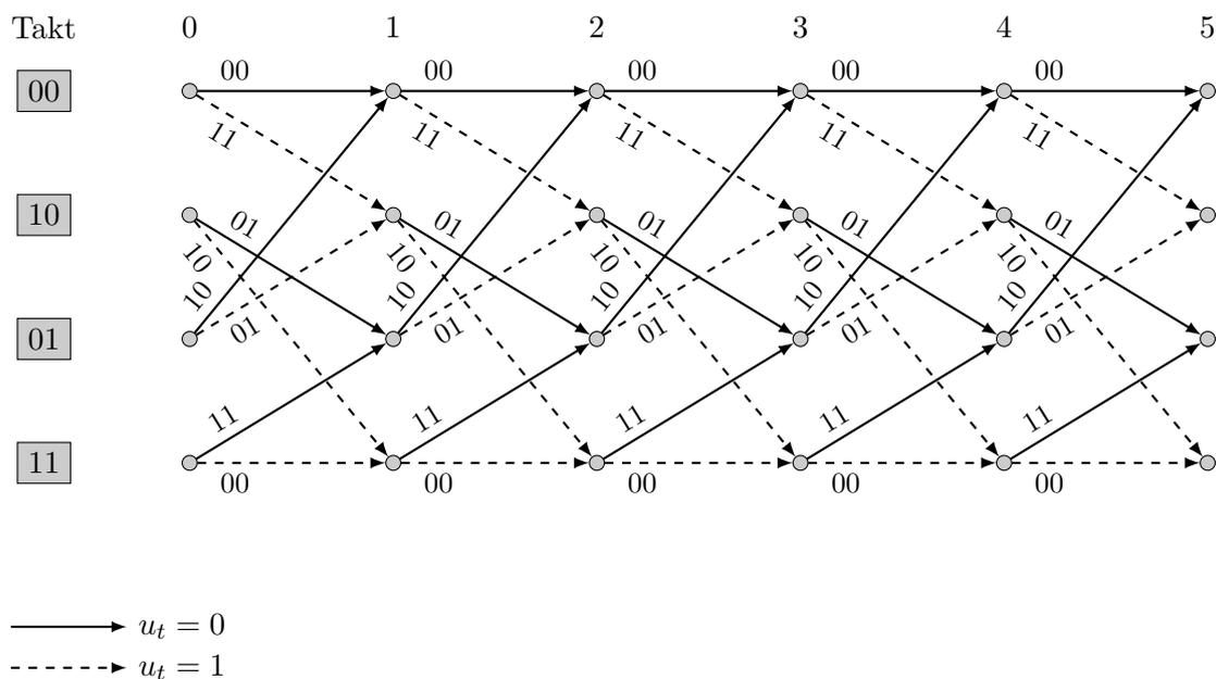
Gegeben ist das Trellis-Diagramm eines binären Faltungscodes.
