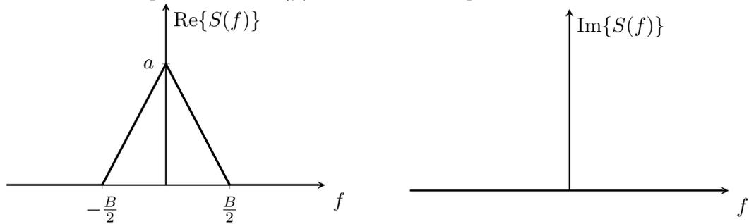
d) Die Energie eines Signals lässt sich mit  $\int_{-\infty}^{\infty} |S(f)|^2 df$  berechnen. Für das gegebene Signal können die Integrationsgrenzen auf  $-\frac{B}{2}$  und  $\frac{B}{2}$  gesetzt werden. Ausserdem kann die Symmetrie um  $f = 0$  genutzt werden:
