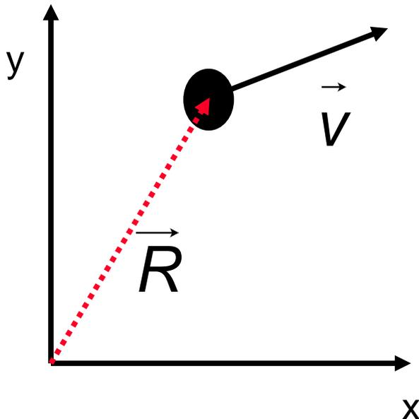
Zum Zeitpunkt  $t$  befindet sich das Teilchen der Masse  $m$  am Ort  $\vec{R}$  und bewegt sich mit der Geschwindigkeit  $\vec{v}$ . Sein Impuls beträgt  $\vec{p} = m\vec{v}$ .
