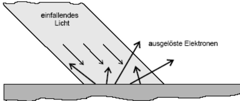
Abbildung 1.2: Licht löst Elektronen aus Metalloberflächen
