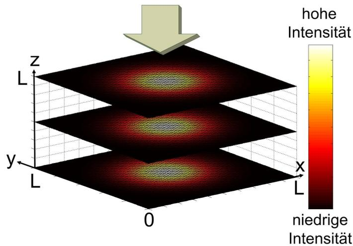
Abb. 3: Gaußscher Laserstrahl trifft auf Halbleiterklötzchen
