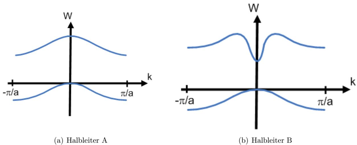
Abbildung 1: Eindimensionale schematische Darstellung der Bandstrukturen zweier Halbleiter.
