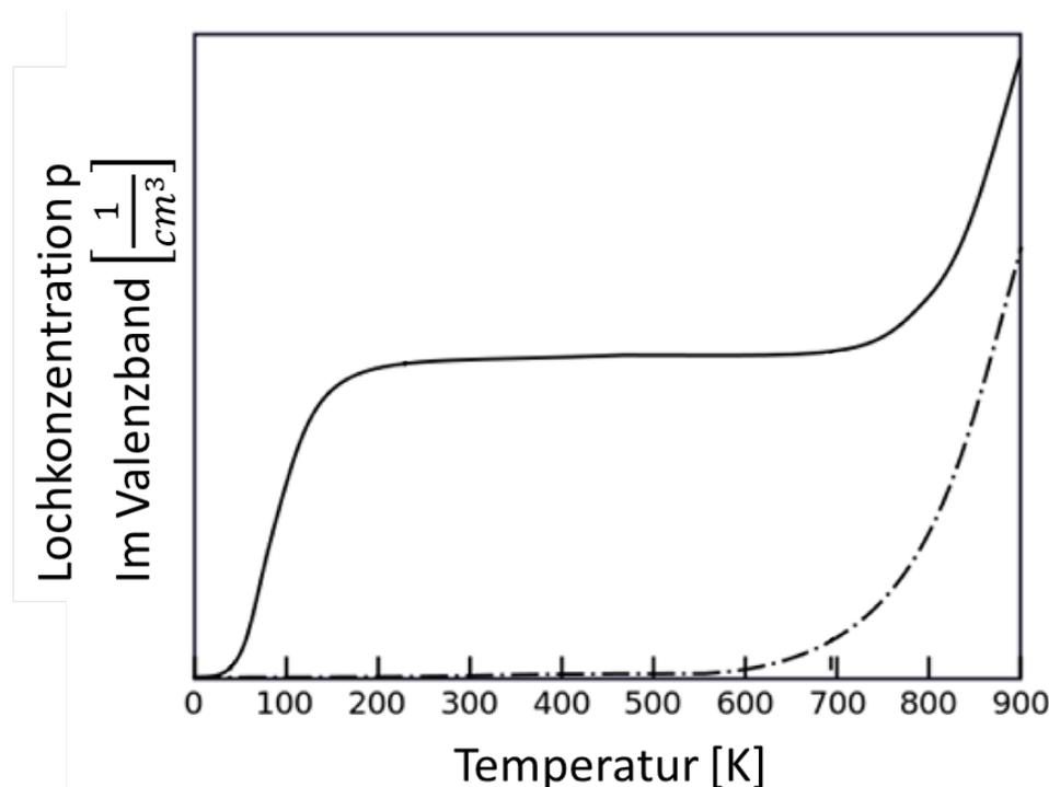
Abbildung 9: Lochkonzentrationen im Valenzband in Abhängigkeit von der Temperatur
