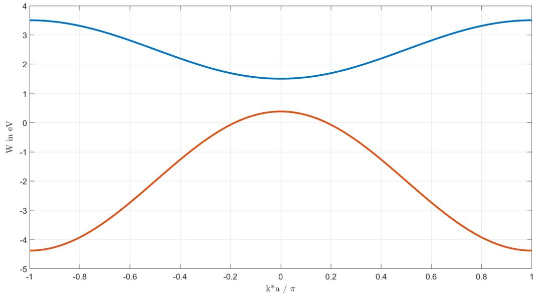
Abbildung 6: Potentiale für Leitungsband  $W_L(k)$  und Valenzband  $W_V(k)$
