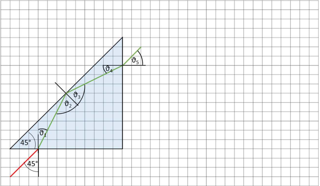
Strahlengang 2: Keine Brechung bei geradlinigem Übergang, dann Totalreflexion.
