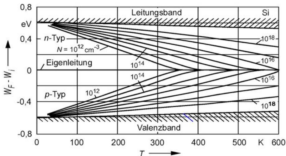
Abbildung 1: Fermienergie über Temperatur
