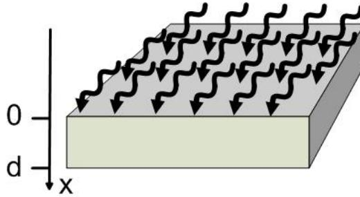
Abbildung 2: Absorption in einem Halbleiter der Dicke  $d$
