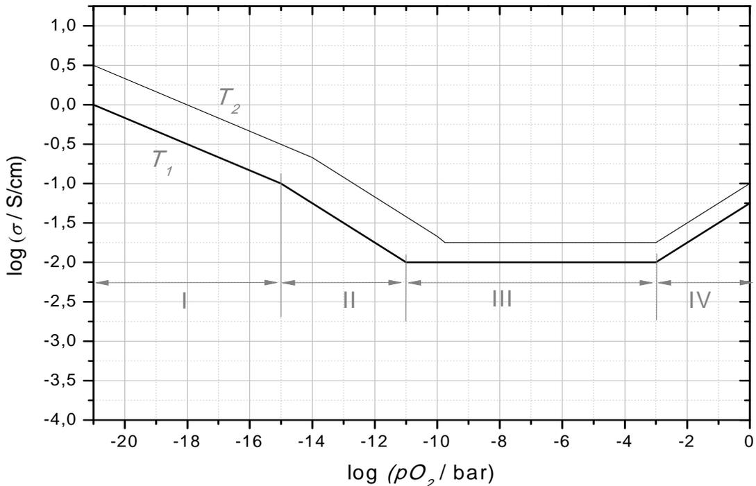
a) Ermitteln Sie aus der gegebenen Kennlinie bei  $T_1=1000$  K die elektronische Leitfähigkeit  $\sigma_n$  und die ionische Leitfähigkeit  $\sigma_{ion}$  für den Sauerstoffpartialdruck  $pO_2 = 10^{-7}$  bar. **(2 Punkte)**
