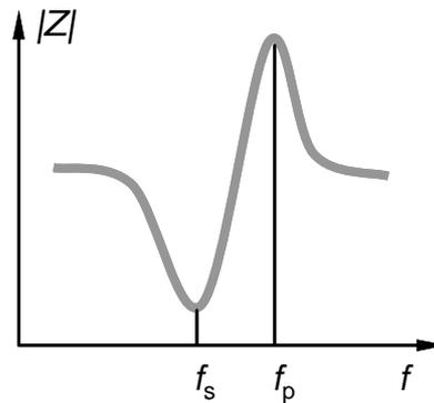
Die Serienresonanzfrequenz  $f_s$  beträgt 3 MHz, die Parallelresonanzfrequenz  $f_p$  beträgt 5 MHz. Berechnen Sie die Werte für  $C_0$  und  $C_1$  des elektrischen Ersatzschaltbildes. (2 Punkte)
