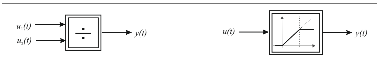
Abbildung 2: Divisionsglied (links) und Begrenzungskennlinie (rechts)
