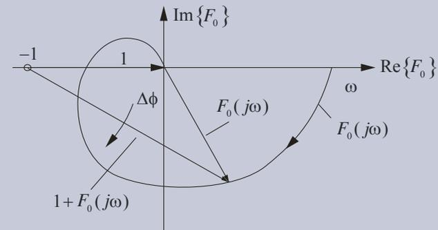
Dabei sind  $r_o$  und  $a_o$  die Pole von  $F_o(s)$  auf und rechts der imaginären Achse, für die zusammen mit den  $l_o$  Polen links der imaginären Achse also gilt:
