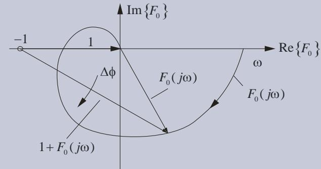
Dabei sind  $r_o$  und  $a_o$  die Anzahl der Pole von  $F_o(s)$  auf und rechts der imaginären Achse, für die zusammen mit den  $l_o$  Polen links der imaginären Achse also gilt:
