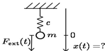
**d) Reifenmodell als Feder-Masse-Dämpfer** ++
