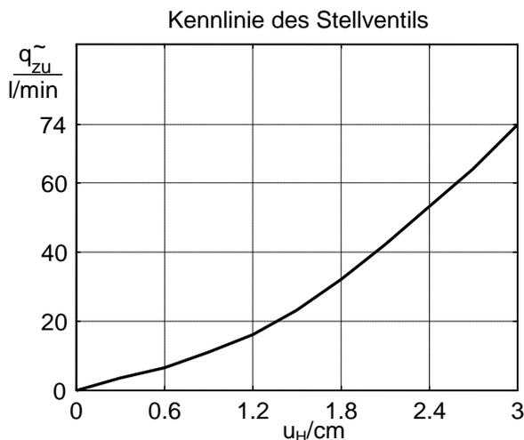
Die Durchflusskennlinie des Stellventils wurde durch Messung ermittelt und ist in nebenstehender Abbildung dargestellt. Sie kann näherungsweise durch die Funktion
