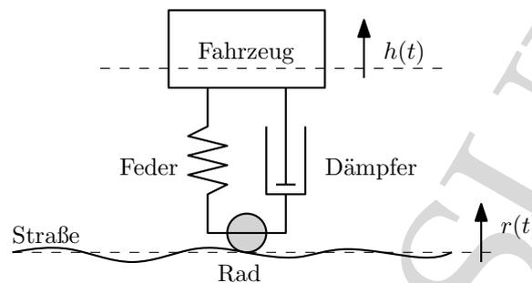
Abbildung 7: Modell eines Fahrzeugs mit Stoßdämpfer.
