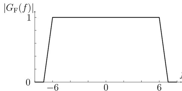
Abbildung 5: Amplitudengang des Filters.
