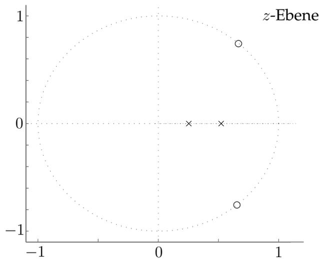
Abbildung L10: Pol-Nullstellen-Plan der Reihenschaltung.
