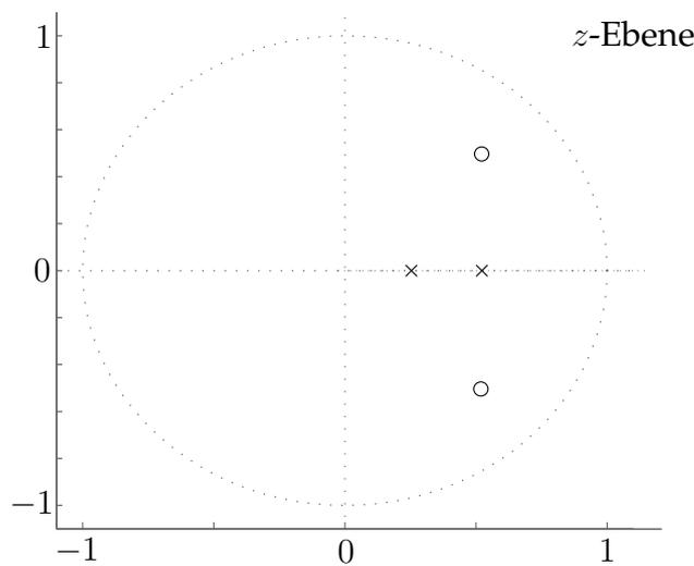
Abbildung L9: Pol-Nullstellen-Plan des zeitdiskreten Systems.
