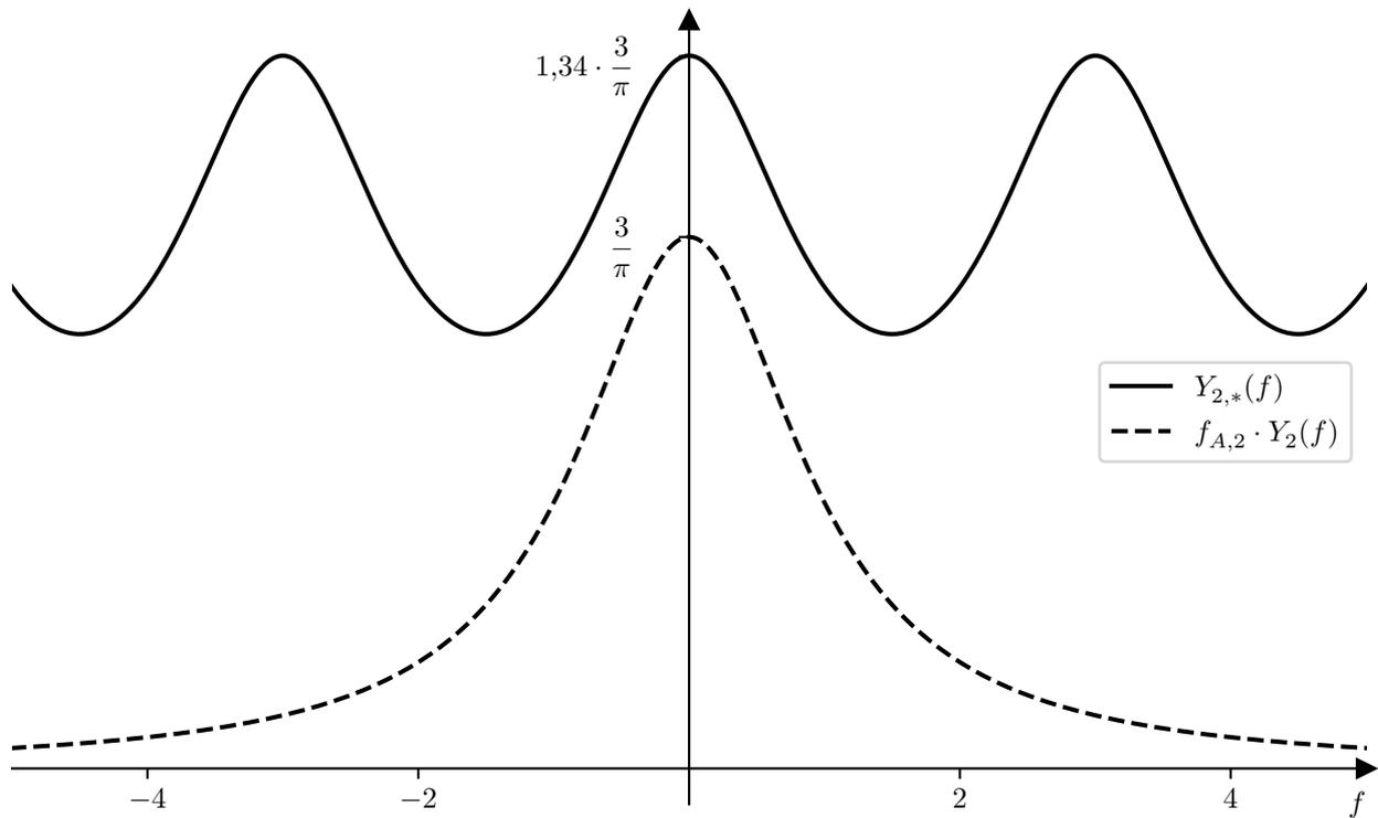
Abbildung L6: Verfälschung des Spektrums durch Aliasing.
