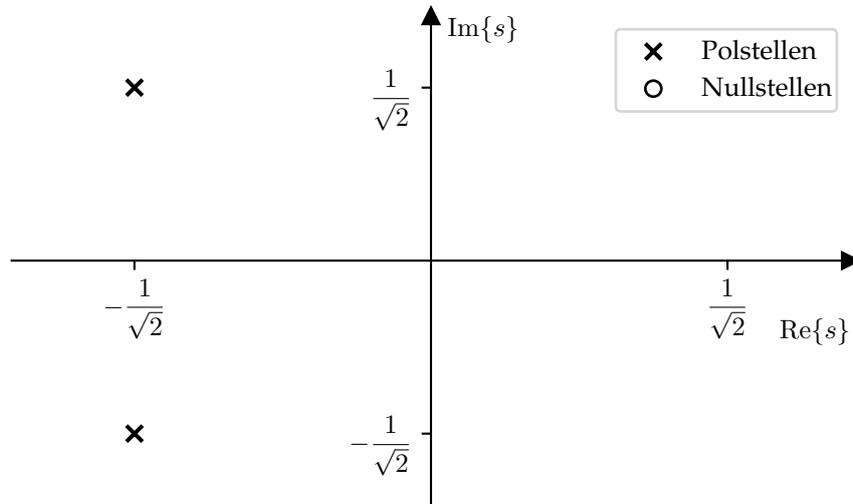
Abbildung 2: Das Pol-Nullstellen-Diagramm des Systems  $\mathcal{S}_1$ .
