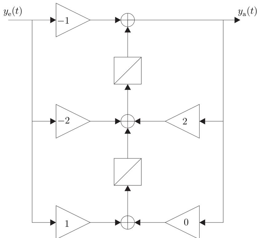
Abbildung L4: Signalflussplan des Systems  $S_2$ .
