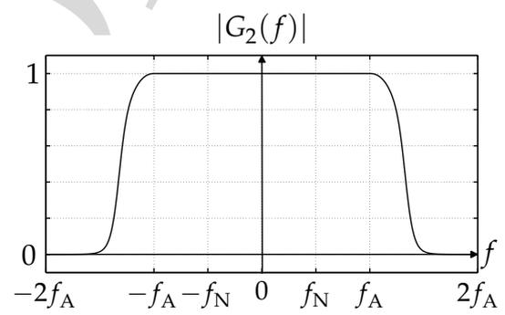
Abbildung 7: Analoge Anti-Aliasing-Filter  $G_1(f)$  und  $G_2(f)$ .
