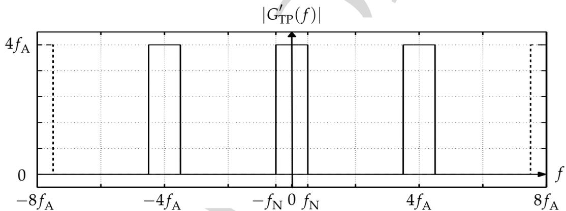
Abbildung L4: Betragsspektrum  $|G'_{TP}(f)|$  des abgetasteten Filters  $g'_{TP,n}$ .
