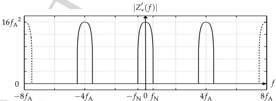
Abbildung L5: Betragsspektrum  $|Z'_*(f)|$  des tiefpassgefilterten Signals.
