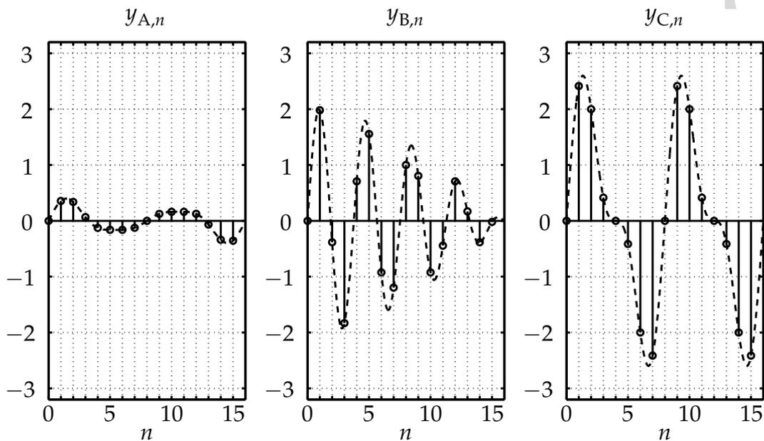
Abbildung 5: Zeitdiskrete Signale  $y_{A,n}$ ,  $y_{B,n}$  und  $y_{C,n}$ .
