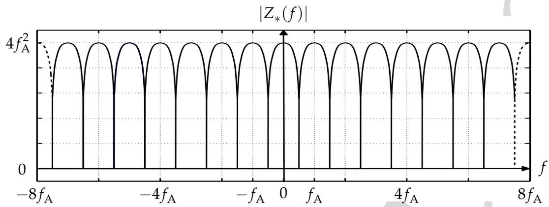
Abbildung L6: Betragsspektrum  $|Z_*(f)|$  des Signals nach dem Downsampling.
