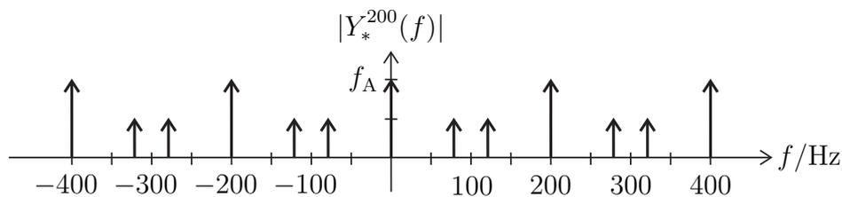
Abbildung L4: Betragsspektrum des Signals  $y(t)$  nach der Abtastung mit  $f_A = 200$  Hz.
