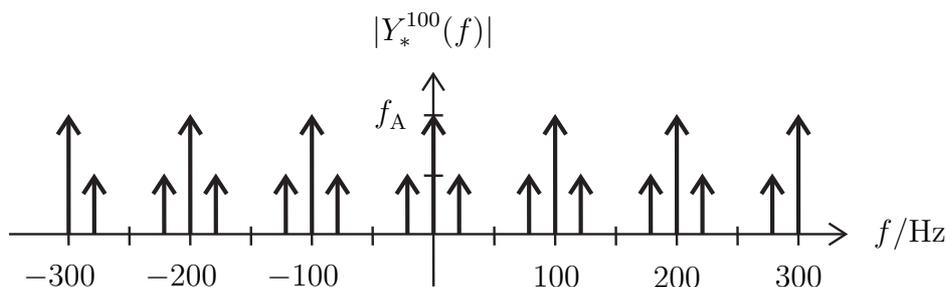
Abbildung L5: Betragsspektrum des Signals  $y(t)$  nach der Abtastung mit  $f_A = 100$  Hz.
