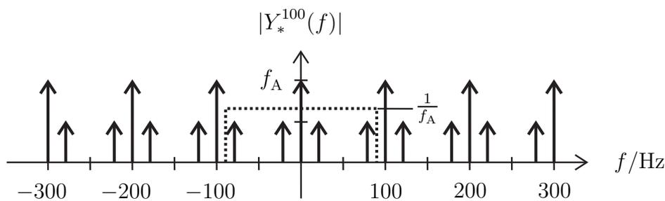
Abbildung L6: Betragsspektrum des Signals  $y(t)$  nach der Abtastung mit  $f_A = 100$  Hz und Rechteckfilter mit der Grenzfrequenz  $f_g = 90$  Hz. (Rechteckhöhe nicht maßstabsgetreu!)
