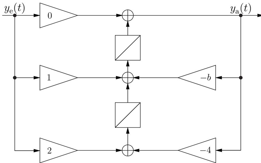
Abbildung L3: Signalflussplan in ARMA-Form.
