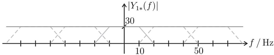
Abbildung L4: Betragsspektrum  $|Y_{1*}(f)|$  des abgetasteten Signals.
