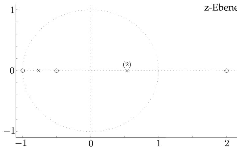
Abbildung L8: Pol-Nullstellen-Diagramm.
