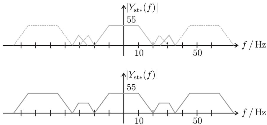
Abbildung L6: Betragsspektrum des überlagerten, abgetasteten Signals. Oben: Periodische Wiederholung der einzelnen Spektren, unten: Überlagerung der Spektren.
