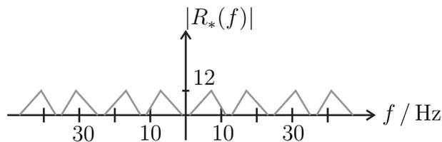
Abbildung L7: Betragsspektrum des unterabgetasteten Signals  $r(t)$ .
