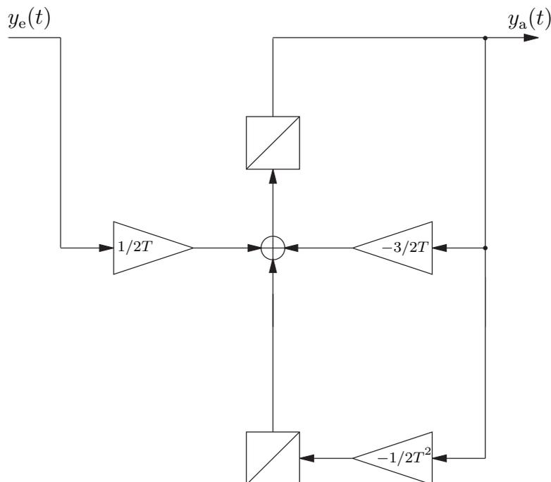
Abbildung L3: Signalflussplan des Systems  $\mathcal{S}_2$ .
