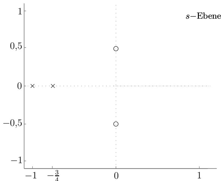
Abbildung 3: Pol-Nullstellen-Plan des Systems  $\mathcal{S}_2$ .
