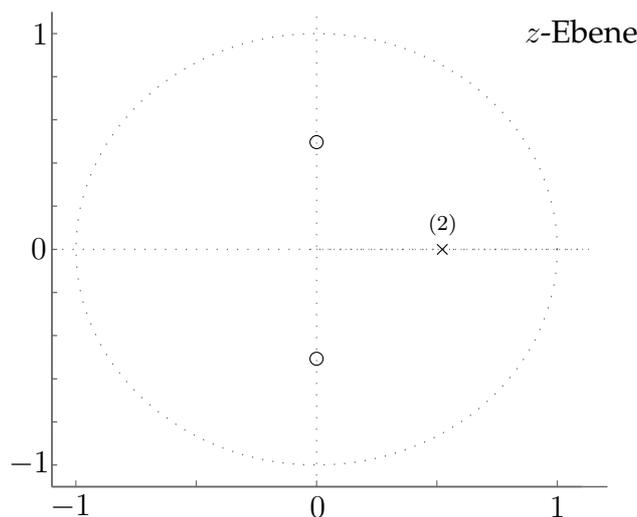
Abbildung L5: Pol-Nullstellen-Plan des zeitdiskreten Systems.
