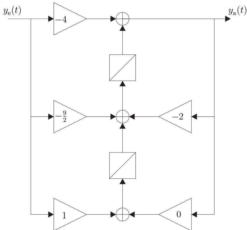
Abbildung L3: Signalflussplan des Systems  $\mathcal{S}_2$ .
