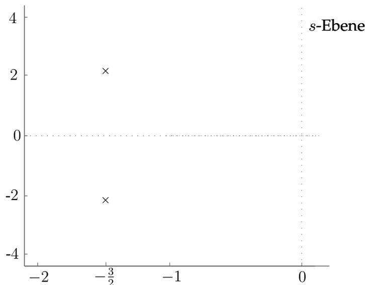
Abbildung L2: Pol-Nullstellen-Plan des Systems  $S_1$ .
