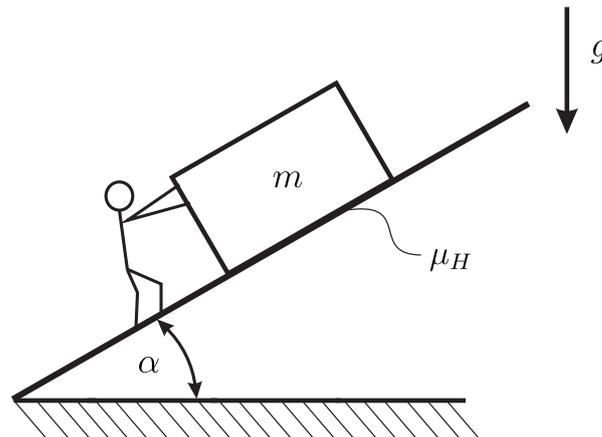
Die Person übt gemäß gegebenem Freischnitt unter dem Winkel  $\beta$  eine Kraft  $F$  auf den Massenblock aus.
