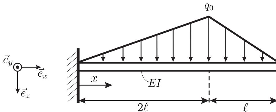
Der Biegemomentverlauf ergibt sich für die dargestellte Belastung durch die Streckenlast wie folgt:
