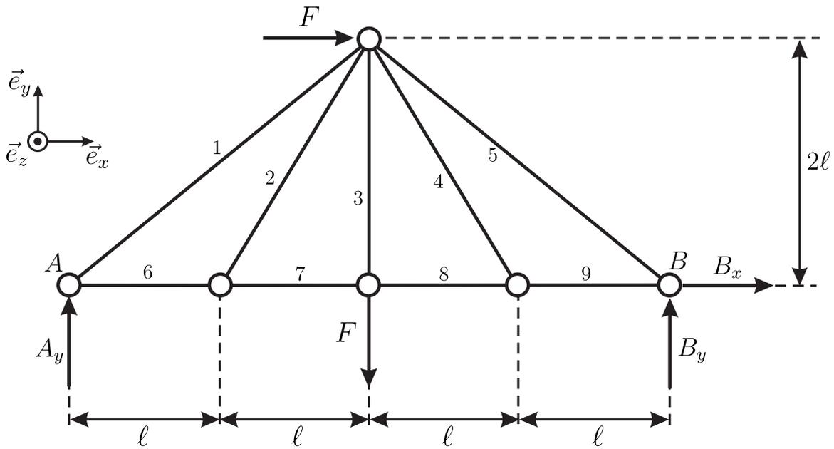
Die Lagerkräfte an den Lagerstellen A und B sind hierbei durch  $A_y = \frac{1}{2}F$ ,  $B_x = -F$  und  $B_y = \frac{1}{2}F$  gemäß der im Freischnitt angenommenen Richtungen gegeben.
