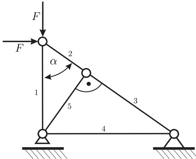
3.3 Wie muss der Winkel  $\alpha$  (mit  $0 < \alpha < \frac{\pi}{2}$ ) gewählt werden, sodass die Belastung von Stab 1 betragsmäßig minimal wird. (1 Punkt)
