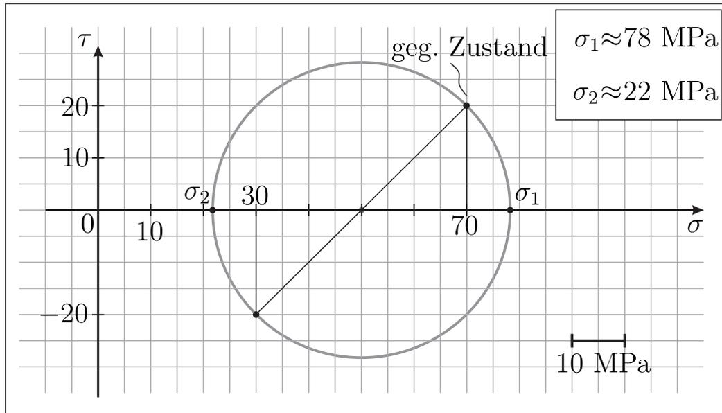
12.1 Wählen Sie unter Berücksichtigung der gegebenen Spannungswerte einen geeigneten Maßstab und ergänzen Sie das Diagramm mit einer entsprechenden Achsenskalierung. Führen Sie dazu eine geeignete Achsenbeschriftung ein und kennzeichnen Sie den vorgegebenen Spannungszustand. (1 Punkt)
