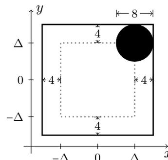
Die Öffnung muss eine Kantenlänge von  $2 \cdot (\Delta + 4 \text{ cm}) = \underline{28,78 \text{ cm}}$  (exakt: 28,56 cm) aufweisen.
