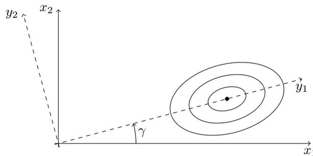
Abbildung 5: Drehung des Koordinatensystems um  $\gamma$ .
