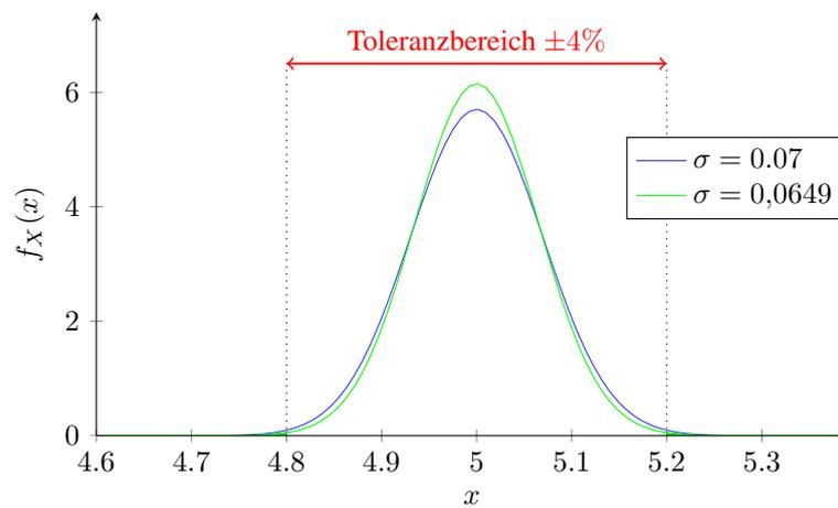
Abbildung 18: Dichte der gemessenen Ladespannung bei  $\mu = 5$  und  $\sigma = 0,0649$
