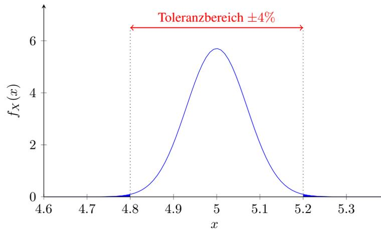
Abbildung 17: Dichte der gemessenen Ladespannung bei  $\mu = 5$  und  $\sigma = 0,07$
