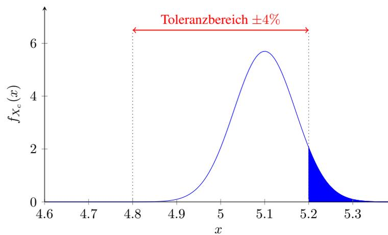
Abbildung 19: Dichte der gemessenen Ladespannung bei  $\mu = 5.1$  und  $\sigma = 0,07$
