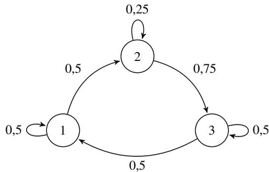
Abbildung 32: Übergangsgraph einer homogenen Markoffkette
