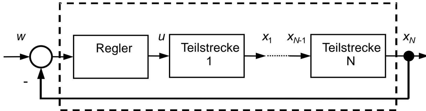
Z.B. bei einer Maschinenachse Regelstrecke für Lage, für Geschwindigkeit und Strom
