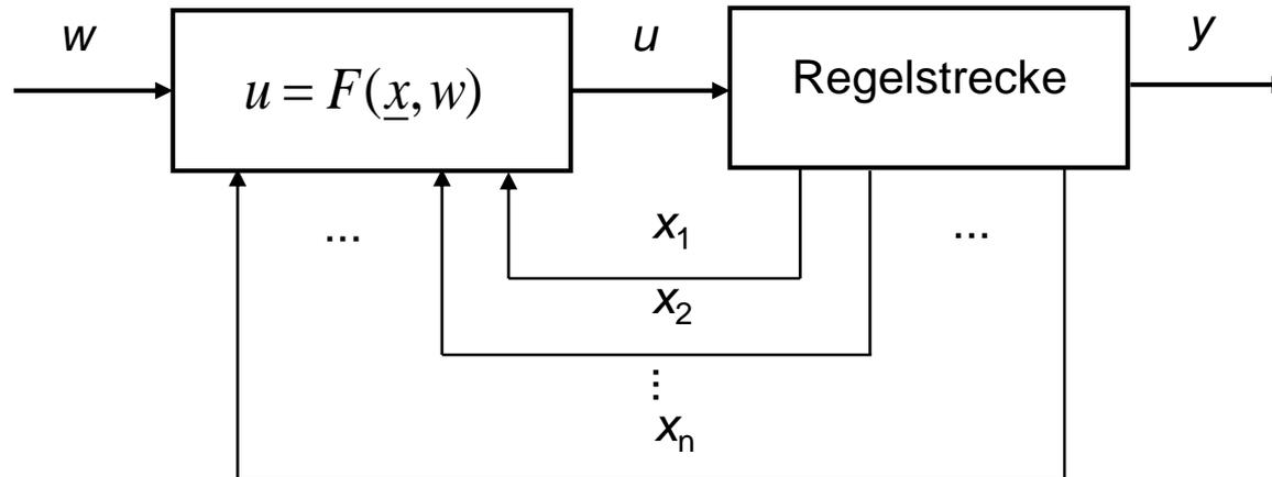
In einem Zustandsregler wird nicht nur die eigentlich interessierende Ausgangsgröße der Strecke zurückgeführt, sondern sämtliche dynamische Größen der Regelstrecke (**Zustandsgrößen**). Bei Zustandsreglern gibt es keine exakte Trennung zwischen dem Differenzglied und dem eigentlichen Regler, weil die Einwirkung jeder Zustandsgröße individuell ist. Dadurch entsteht ein mehrschleifiger Regelkreis:
