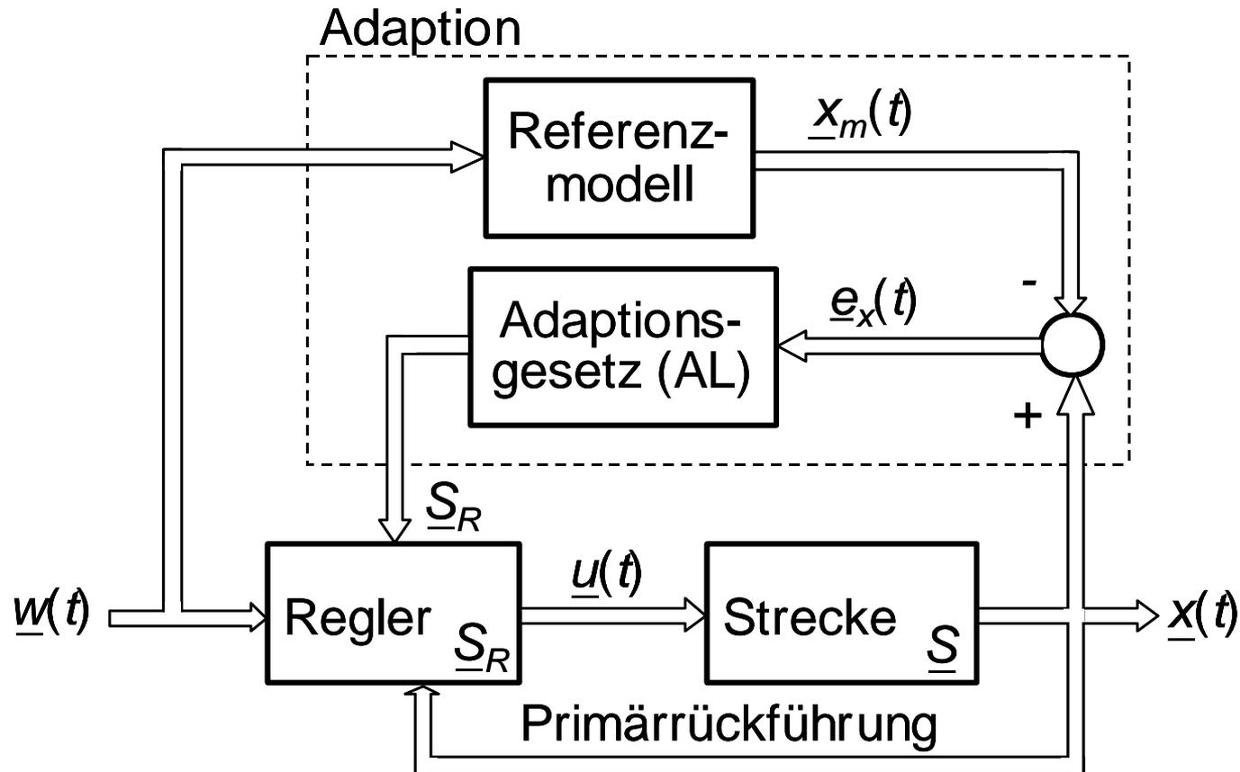
Bei den **direkten** adaptiven Reglerstrukturen werden die Reglerparameter direkt aufgrund der zur Verfügung gestellten Signale bestimmt. Bei dieser Methode werden die Reglerparameter direkt durch ein **Adaptionsgesetz (AL: adaptation law)** so verändert, dass das Verhalten der Ausgangsgröße  $\underline{x}(t)$  einem **Referenzmodell** angeglichen wird, welches das gewünschte Systemverhalten beschreibt.
