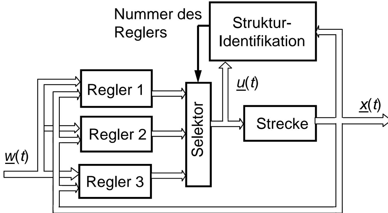
**Strukturadaptive** Regelsysteme sind Systeme, bei denen entsprechend der sich in der Struktur ändernden Regelstrecke (z.B. Systemordnung) die Struktur des Reglers entsprechend angepasst (adaptiert) wird.
