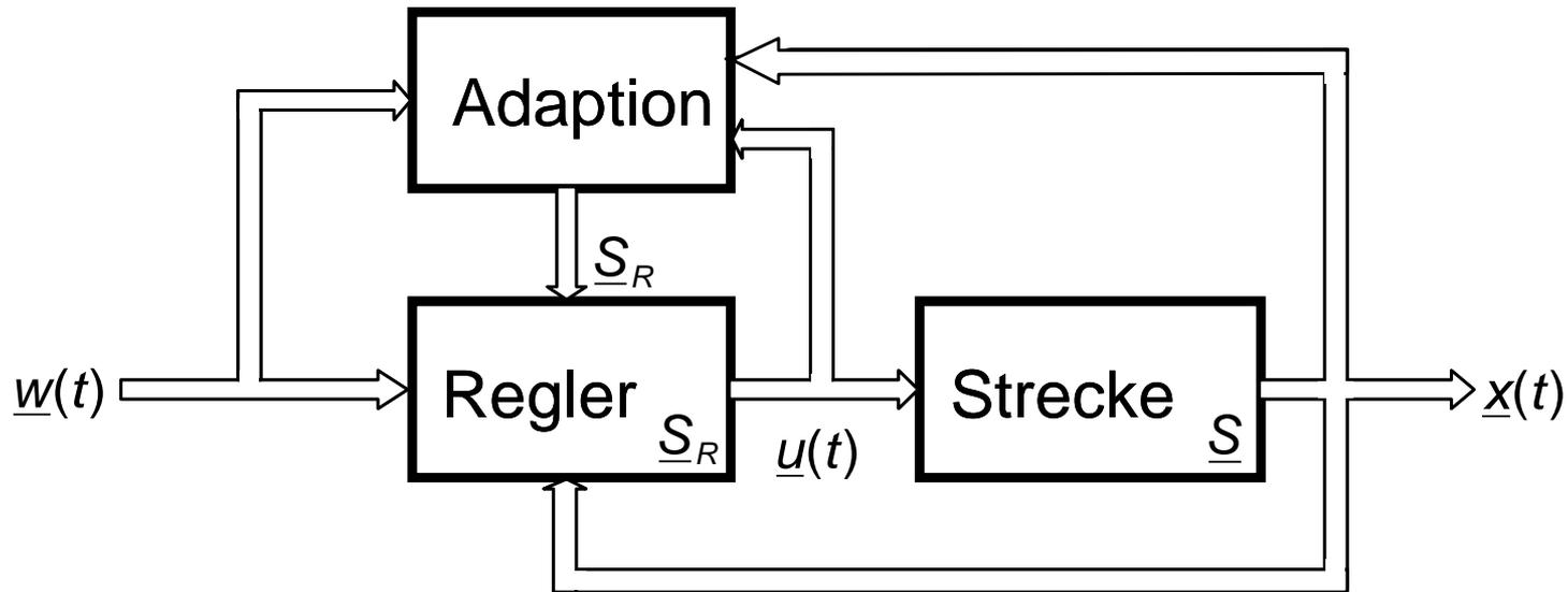
**Parameteradaptive** Regelsysteme sind Systeme, bei denen ein adaptiver Regler seine Parameter der sich ändernden Regelstrecke entsprechend anpasst (adaptiert).
