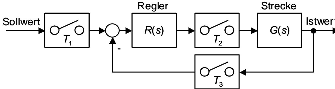
Reale Systeme werden immer so gestaltet, dass  $T_1 \geq T_2 \geq T_3$  ist.
