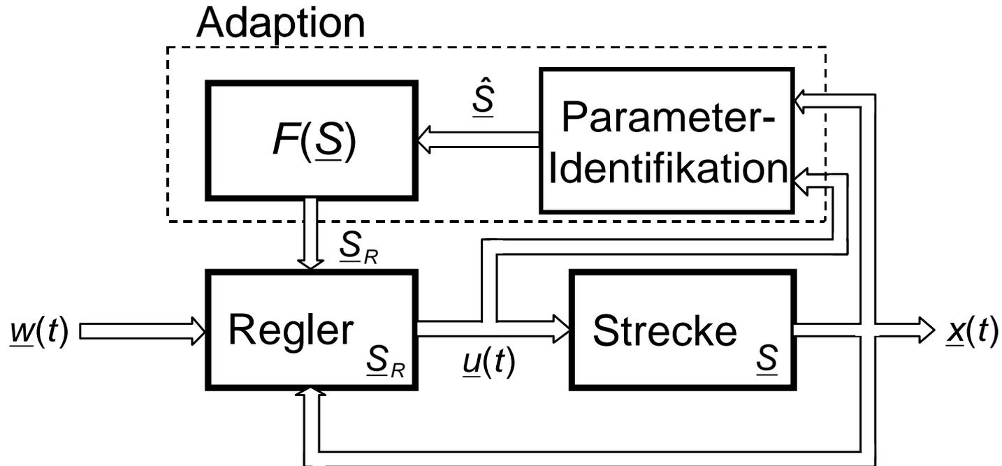
Bei der indirekten adaptiven Regelstruktur werden die Reglerparameter indirekt über die Streckenparameter  $\underline{S}(t)$  bestimmt:
