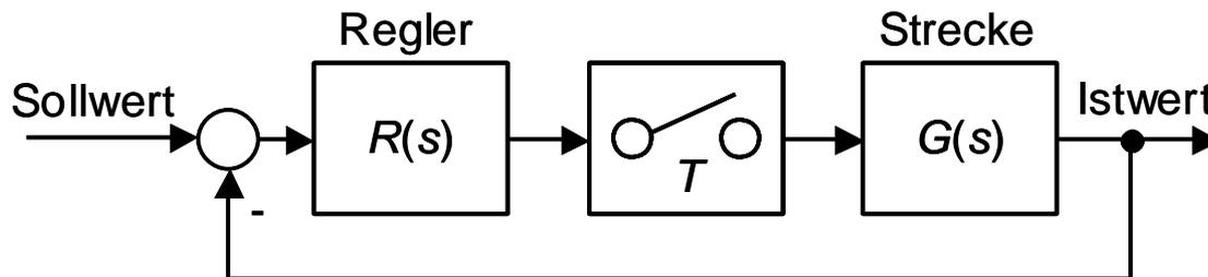
*Sind in einem Signal  $x(t)$  die Frequenzen in einem Band von  $0 - f_{max}$  vorhanden, so reicht es, das Signal  $x(t)$  in zeitlichen Abständen  $T_0=1/(2 f_{max})$  abzutasten, um aus der Funktion  $x_N$  die ursprüngliche Größe  $x(t)$  ohne Verlust an Information zurückzugewinnen zu können.*
