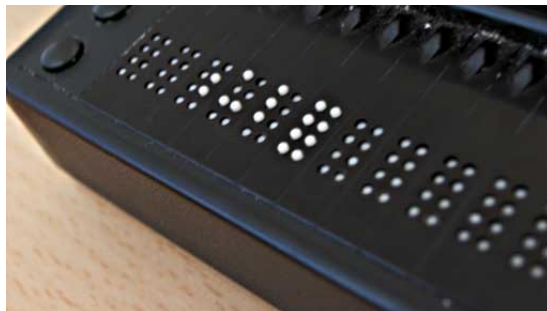
Abbildung 2.1: Eine Braillezeile, Quelle: http://commons.wikimedia.org/wiki/Image:Refreshable_Braille_display.jpg (10.10.2008)
