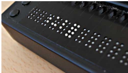
Abbildung 2.1: Eine Braillezeile, Quelle: http://commons.wikimedia.org/wiki/Image:Refreshable_Braille_display.jpg (10.10.2008)
