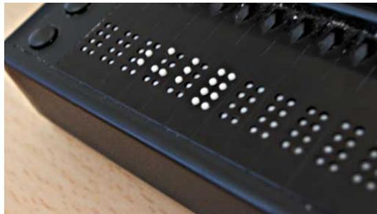
Abbildung 2.1: Eine Braillezeile, Quelle: [http://commons.wikimedia.org/wiki/Image:Refreshable\\_Braille\\_display.jpg](http://commons.wikimedia.org/wiki/Image:Refreshable_Braille_display.jpg) (17.10.2013)
