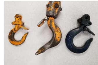
Unzulässige Verformung von Kranhaken
