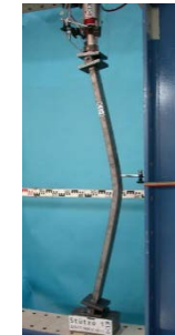
Knicken eines Trägers
