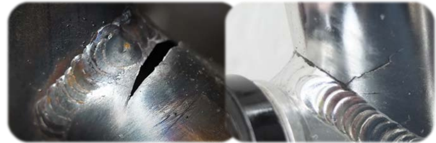
Risse an der Schweißnaht bei Rohrverbindungen (z.B. Fahrradrahmen)
