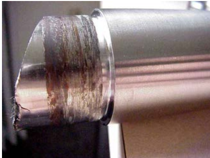
Schwingbruch an Antriebswelle ausgelöst durch Reibkorrosion
