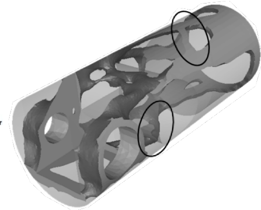
Leichtbau-Designvorschlag als Ergebnis der erweiterten Topologieoptimierung
