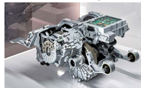
Hinterachse Taycan E-Maschine mit 2-Gang-Getriebe
