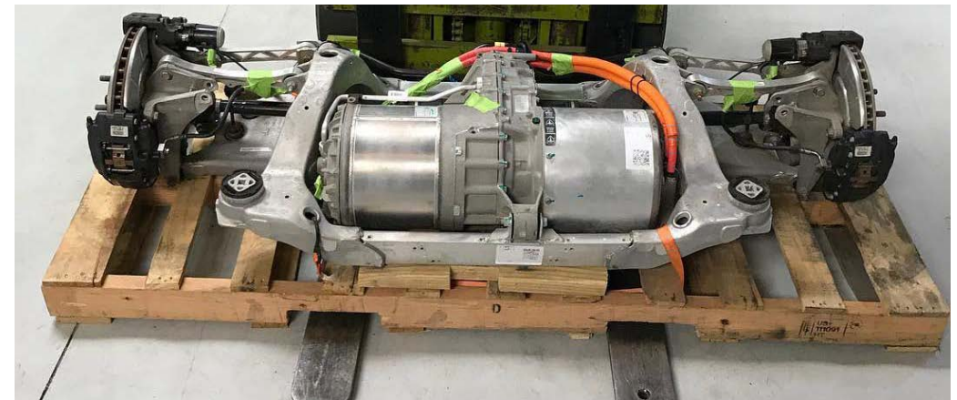
Hinterachse eines Teslas mit ASM (Im Gegensatz zu SM im Taycan)
