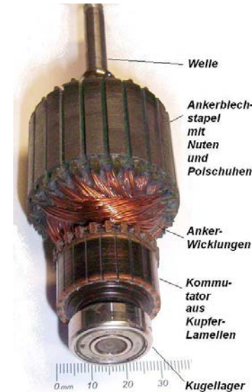
Rotor eines Gleichstrommotors mit Kommutator
