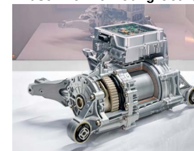
Vorderachse Taycan E-Maschine mit 1-Gang-Getriebe
