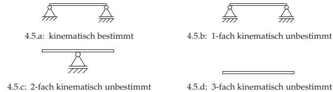
Abb. 4.5: Beispiele zur kinematischen Bestimmtheit
